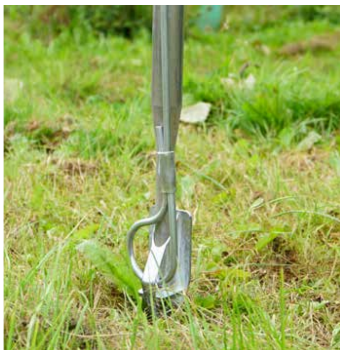
Apex 3 avec tige rigide en train d'être enfoncée
