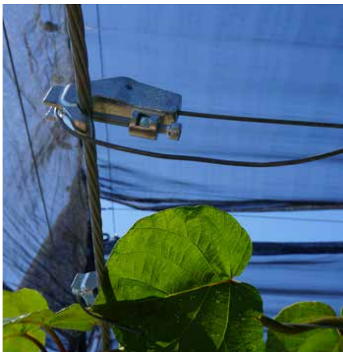
GP90 gebruikt om draadlijn te vormen
