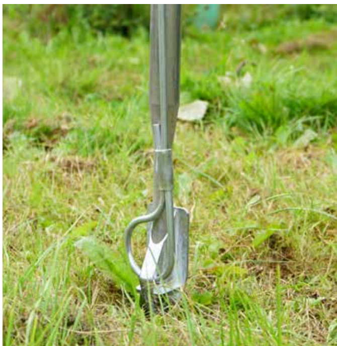
APEX 3 met Stang wordt in de grond ingebracht
