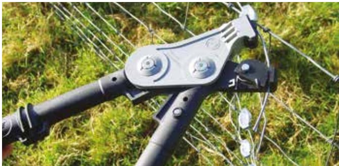
Haut : Palissage avec une Torq Tool 8 et un Gripple Plus Medium Bas : Réparation d'une clôture à l'aide de Gripple Plus Medium et d'une Torq Tool 5.
