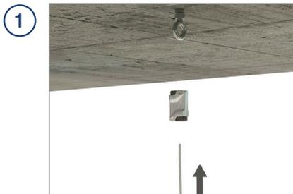
1 Faire passer le câble libre du Y-Fit dans l'un des canaux du HangPro, puis boucler le câble libre dans l'ancrage de plafond ou la boucle Y-Fit.
