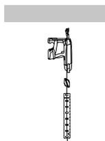
天井スラブにワイヤ端末金具を打鋺し、ワイヤを固定。
